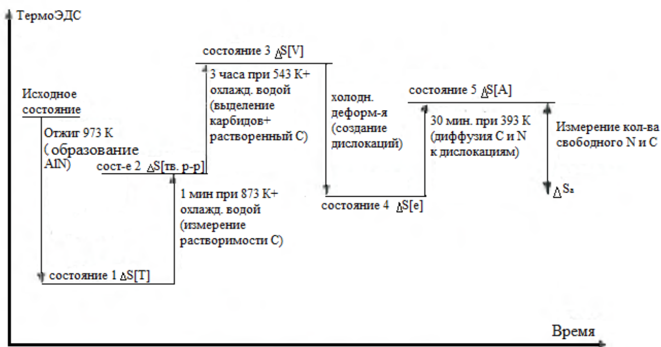
Рисунок 10. Схема проведения эксперимента с применением метода термоЭДС [86].
